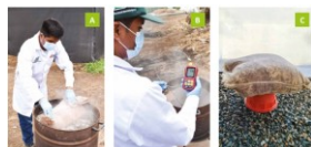
PASTEURIZACIÓN (esterilización por agua caliente 70 y 80° C)
